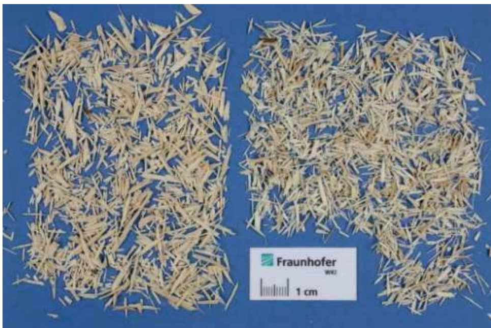
Abb. 3: Späne der gleichen Siebfraktion (Siebmaschenweite: 1,25 mm - 3,15 mm) der Holzart Buche (linke Bildhälfte) und der Holzart Fichte (rechte Bildhälfte)
