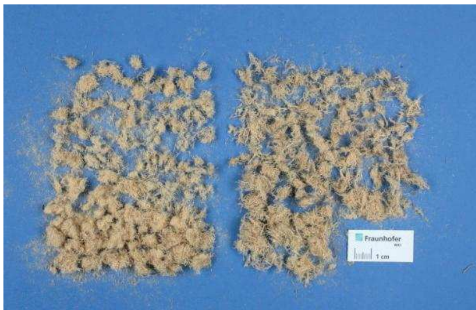
Abb.5: Buchenfasern, TMP-Aufschluss mit 0,4 mm (links) und 1 mm (rechts) Mahlplattenabstand
